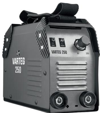
Аппараты VARTEG разработаны и сделаны для профессионалов, главные особенности – мощность, надежность, компактность. Улучшенная схема стабилизации сварочного процесса дает хороший поджиг и «мягкую» сварочную дугу с минимальным разбрызгиванием. Данное устройство позволяет производить сварку постоянным током, используя инверторную технологию преобразования и управления сварочным током.
